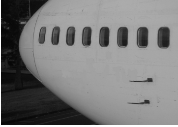
FIG. 1.7.2. Tubes de Pitot. Prises dynamiques de la sonde Pitot d'un Boeing 747. L'avion est équipé de plusieurs prises pour plus de sécurité.
